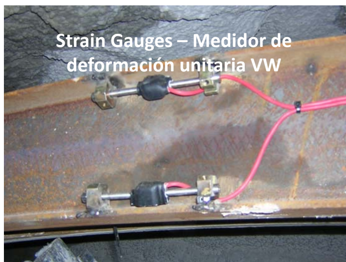
Estado tensional del refuerzo
