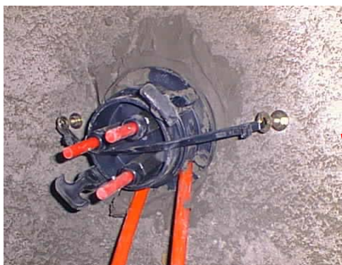
Extensómetro multipunto de hoyo
